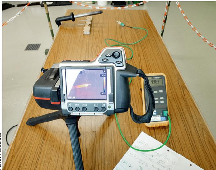
Die maximalen Temperaturen am Brenning wurden im Labor mit Wärmebild-Kameras gemessen.
